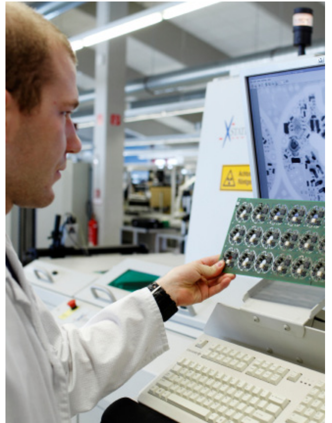
Sıcaklık trans미터inin X-ışını ile kalite kontrolü
